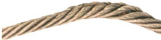
Figure D.4 - Extrusion de torons
