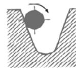
2.7 Pour la même raison, il est essentiel de veiller à ce que le touret du câble neuf soit orienté de façon à éliminer un angle de déflexion sur les réas de la machine à équiper (chariot de grue ou tête de flèche). Il convient également de veiller à ce que la moufle de levage déposée à terre soit convenablement orientée et toujours dans ce même plan.
