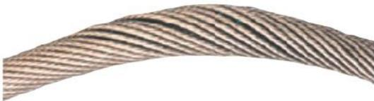
Figure D.9 - Déformation en panier
